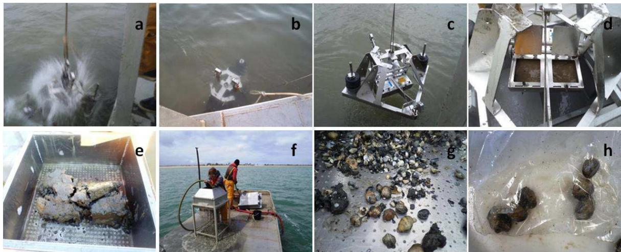
**Figure 3** : Différentes étapes du prélèvement : Benne jetée par-dessus bord (a) puis enfoncée dans le sédiment (b). Relève de la benne (c). Sédiment collecté (d), disposé sur la table de tri (e) et rincé à l'eau de mer (f). Palourdes présentes dans l'échantillon (g) puis conservées pour analyse (h).
