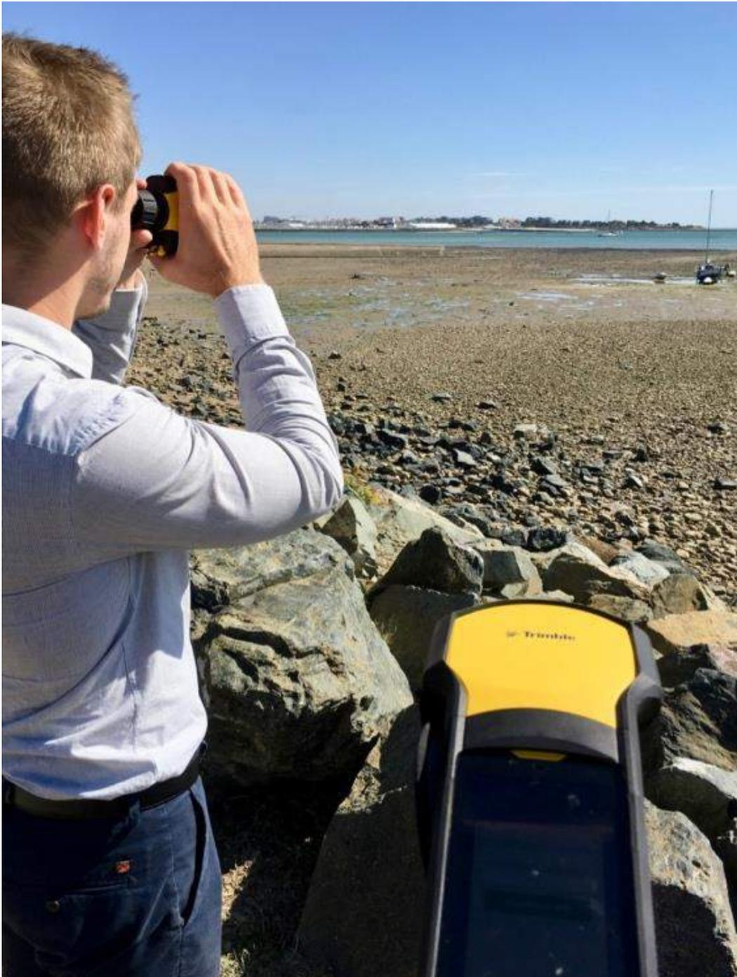
La précision du pointage n'a pas été comparée avec un autre appareil de mesure. Cependant, le carnet de terrain annonçait une précision inférieure à 1 mètre.
