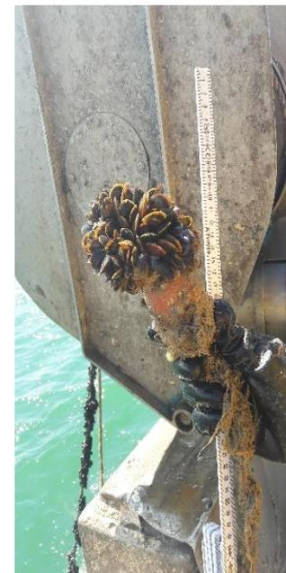
Figure 18 : flotteur colonisé et alourdi par des moules
